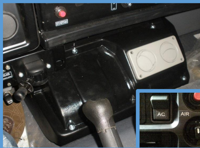
Кондиционер кабины для регионов с жарким климатом, в т.ч. для экспорта.
