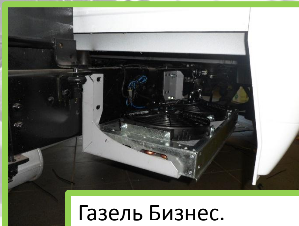
ГАЗель, Валдай, ГАЗ-3309. Кондиционер кабины под сиденьем
