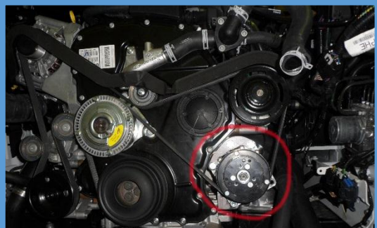
Универсальный компрессор SANDEN, оригинальный ремень 7pk3120
