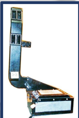
ГАЗель, Валдай, ГАЗ-3309. Кондиционер кабины под сиденьем
