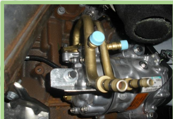
Оригинальный компрессор SANDEN 7V16
